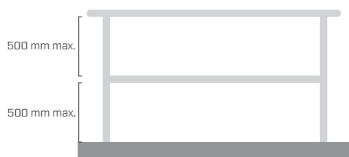
BARANDA SIN RODAPIÉ
